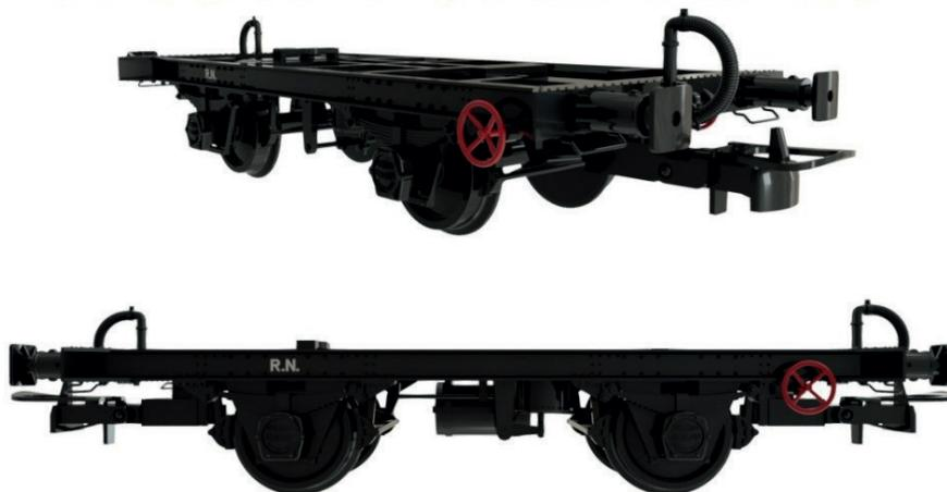
40025 - Caja con 4 bastidores unificados con freno de vacío, volante de freno de estacionamiento, cajas de grasa RN21 y asideros bajo los topes. Épocas III-IV.
