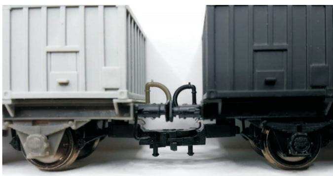
**Nuevos bastidores con mejoras en el rodaje y en la cinemática de enganche corto, que permite la circulación tope contra tope con funcionalidad de los mismos cuando se utilizan con cabezas intercambiables de enganche corto de diversas marcas. Radio mínimo de giro recomendado: 430mm**
