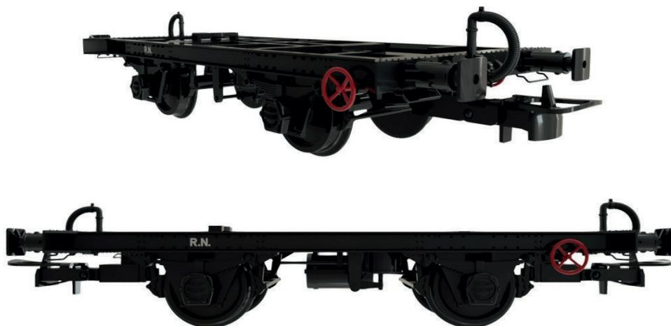
40029 - Bastidor unificado con freno de vacío, volante de freno de estacionamiento, cajas de grasa RN21 y asideros bajo los topes. Épocas II-III. En color negro integral con la inscripción R.N. en ambos costados. Listo para rodar.
